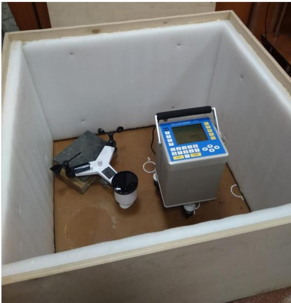
Рисунок 3.19 – Расположение гравиметра CG-5 Autograv и датчиков метеостанции «meteoscan 937PRO» внутри изолирующего короба
