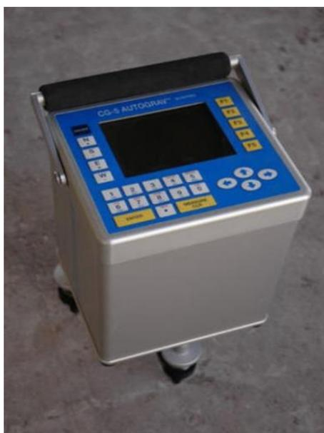
Рисунок 1.3 – Относительный автоматизированный гравиметр
