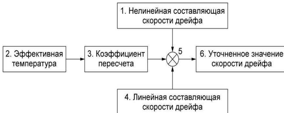
Рисунок 3.16 – Структурная схема модели компенсации нелинейной составляющей дрейфа по значению “эффективной” температуры (сумматор обозначен кружком)
